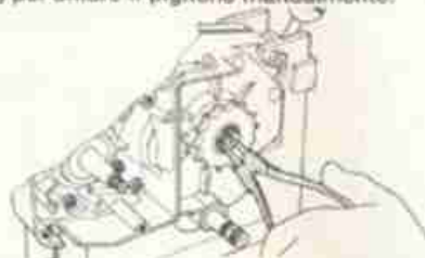
FIG. 11 Rimozione seeger pignone catena Chain sprocket snap ring removal
