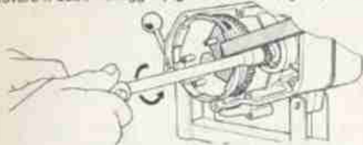
FIG. 13 Rimozione dado pignone motore Pinion nut removal
