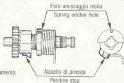
FIG. 46 Registrazione frizione Clutch adjustment
