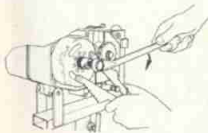
FIG. 9 Estrazione girante volano Flywheel magnet rotor pulling
